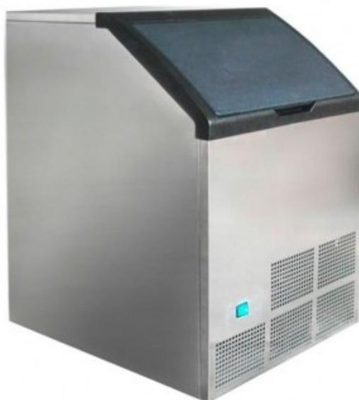
Máquina fabricadora de hielo. Para hoteles, restaurantes, bares. Producción hasta 43 kg/24 hrs. Estructura fabricada en acero inoxidable. Tapa frontal plástica con contenedor interior con capacidad de 23 kg. Potencia 315 W - 220V/50Hz. Medidas: 51 x 56 x 82 cm
